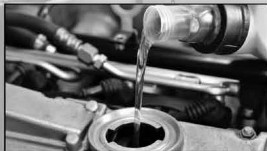
L'huile minérale provient du raffinage du pétrole brut alors que l'huile synthétique n'est pas d'origine naturelle. En effet, l'huile synthétique est un produit de laboratoire. Elle est distillée, purifiée et décomposée en ses molécules de base, créant ainsi une huile avec une viscosité et une homogénéité parfaite.
